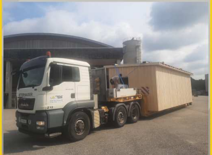
Transport mit Tiefbett einer Holzkonstruktion
